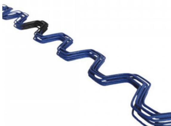
Este alambre en forma de zig zag permite la fijación de los plásticos del invernadero a los perfiles instalados en las estructuras. Únicamente tendrá que emplazar el plástico o la malla del invernadero sobre el perfil e introducir el alambre estirando hasta que ajuste dentro del perfil dejando fijado el plástico. Este tipo de perfiles permiten un cambio rápido de los plásticos del invernadero por rotura, deterioro o cambio de temporadas. El alambre zig zag tiene una longitud de 2 metros.
